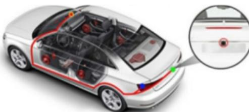
После завершения монтажа выносной камеры подключите ее к выключенному комбинированному устройству через специально предусмотренный порт и только после этого подайте питание.
