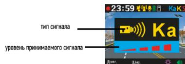
Вид экрана при работе в режиме радар:
