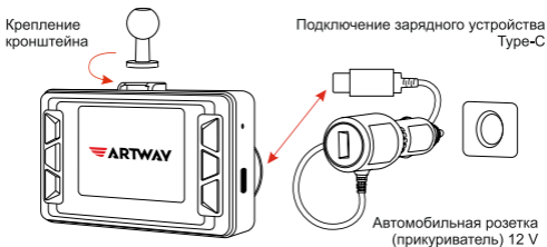
Крепление кронштейна и подключение питания
