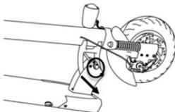
1. Извлеките фиксатор складного механизма
