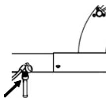
2. Подключите штекер зарядного устройства к данному порту. Для полной зарядки требуется примерно 4 часа
